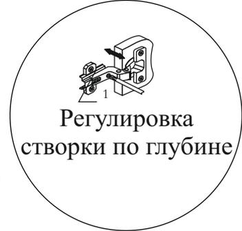
Регулировка створки по глубине
