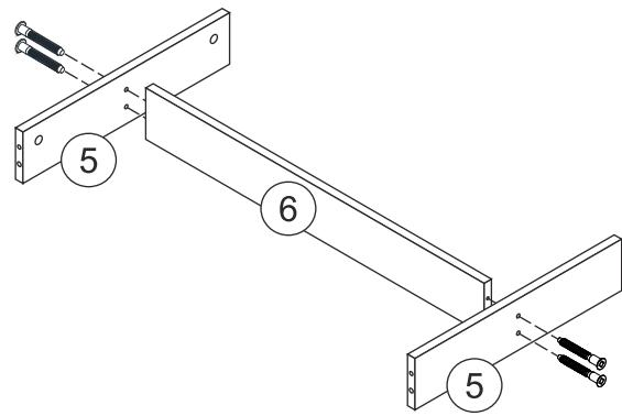
2. Сборка производится горизонтально, тыльной стороной вниз. Тягу 6 скрепить с тягой 5 при помощи еврошурупов 7\*50 мм.
